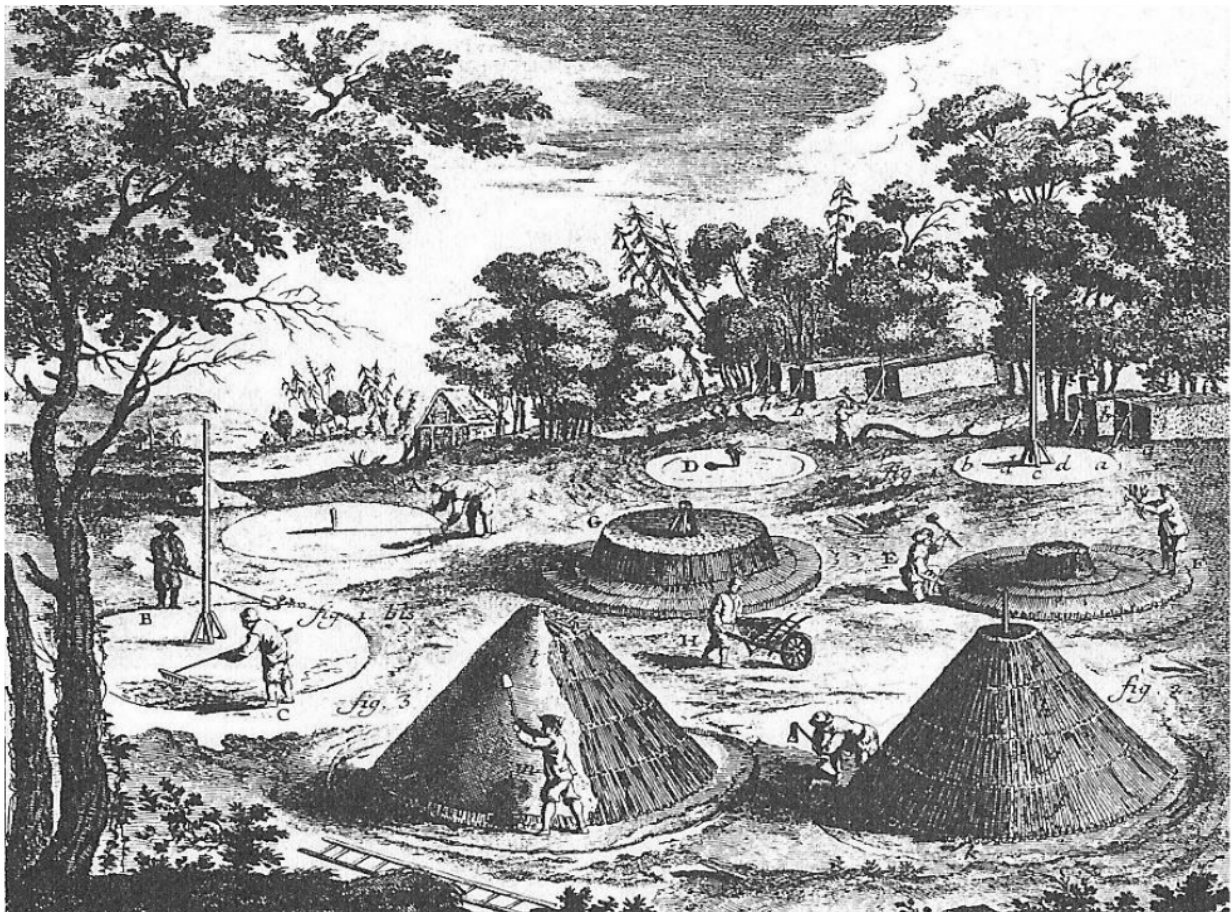
Köhler beim Betreiben einer Kohlstätte, acht Meiler in verschiedenen Fortschrittsstufen (Abbildung aus der Publikation)
