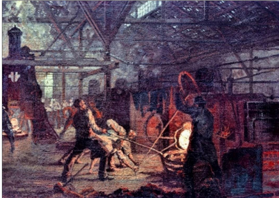
Das Gemälde von Otto Bollhagen (1861-1924) zeigt das Herausziehen der Luppe aus dem Puddelofen
